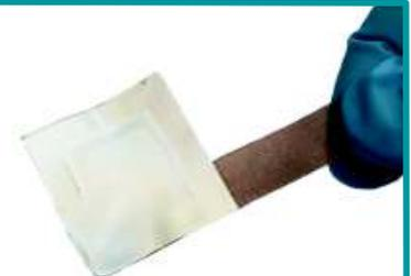
Abb. 3: Elektrogesponnenes Vlies auf einem Leiter aus Kupfer zum Einsatz in der mikrobiellen Brennstoffzelle (MBZ)
