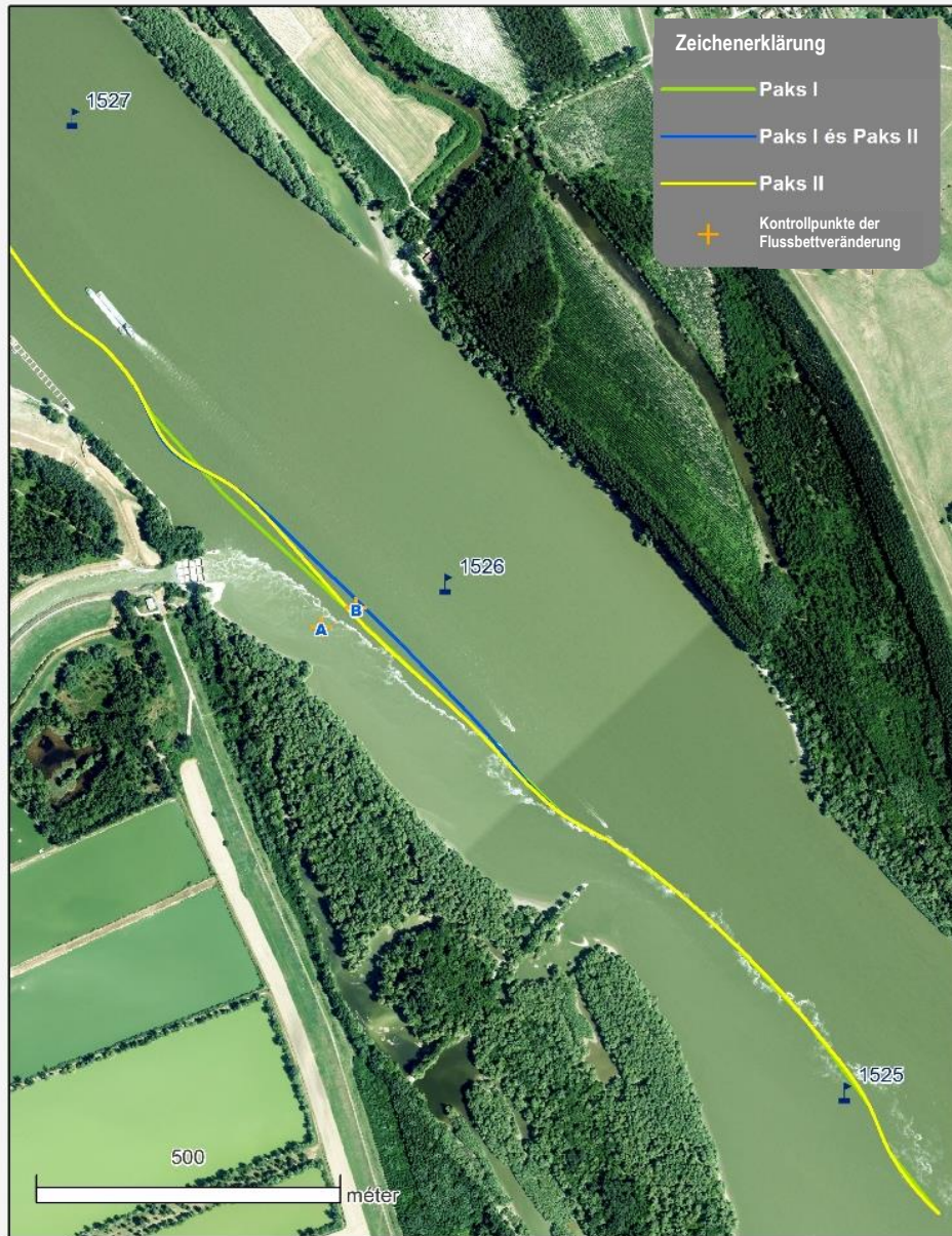
Abbildung 59: Veränderung der berechneten Donau-Strömungslinien im Fall einer Donau-Wasserführung von 2\,300\text{ m}^3/\text{s} (durchschnittliches hydrologisches Jahr), in drei Betriebszeitpunkten: Kernkraftwerk von Paks alleine, Kernkraftwerk von Paks und Paks II zusammen, Paks II alleine
