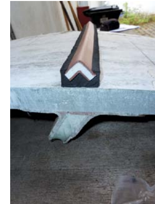
Positionierung der Ladung auf dem Rotorblattsteg
