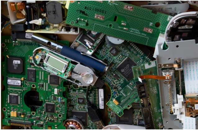
Abbildung 12: Gesammelte Bauteile aus Elektroaltgeräten
